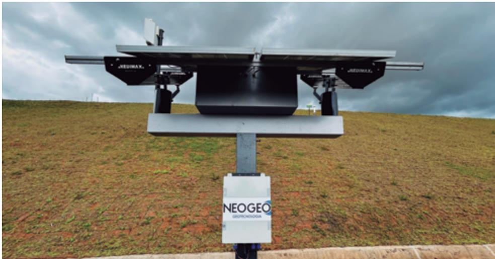
Instalação e operação de estação de monitoramento microssísmico com o sistema GeoTrack.
