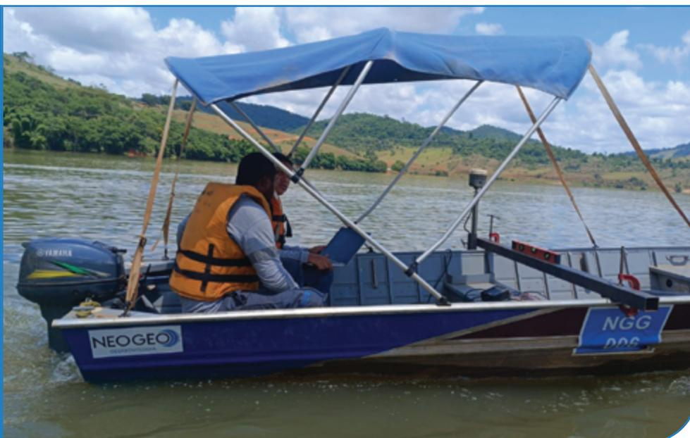
Embarcação utilizada para levantamento batimétrico.
