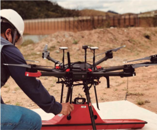
Equipamento GPR acoplado a *drone* para monitoramento aerolevanteado de rejeitos em reservatórios.
