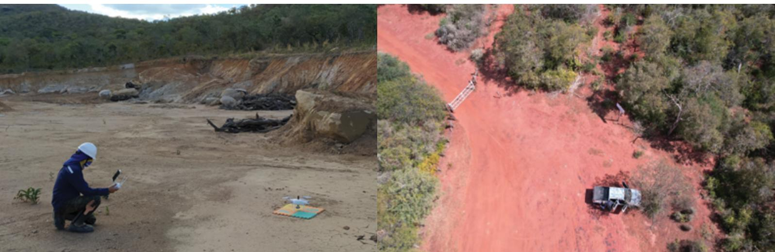
Aquisição aerofotogramétrica. Esquerda: decolagem do *drone* para aquisição de dados; Direita: exemplo de imagem obtida pelo *drone*, no contexto de uma área de investigação.
