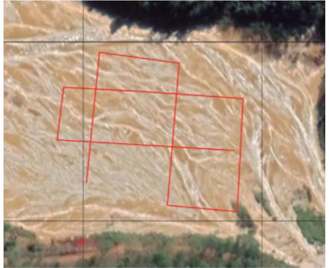
Plano de voo para aquisição por GPR aerolevanteado.
