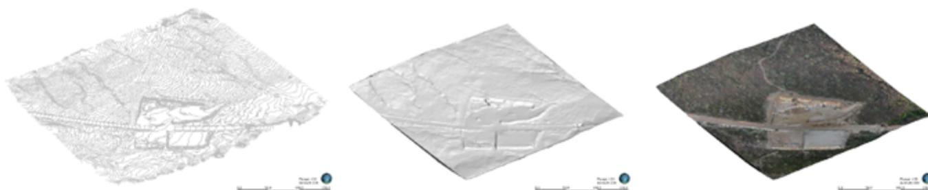
Exemplos de produtos gerados pela Aerofotogrametria. Esquerda: Curvas de nível; Centro: Superfície modelada; Direita: Ortofoto.
